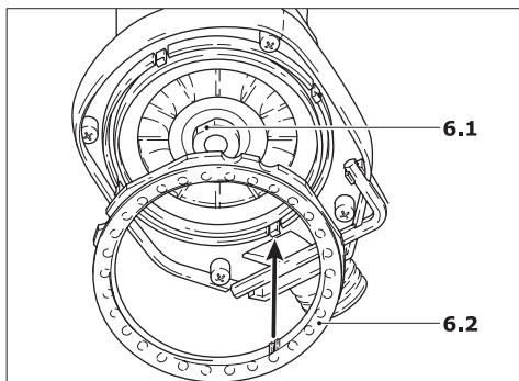
A fin de evitar una aceleración incontrolada del plato de lijado, ésta es frenada por medio de una guarnición (6.2). Debido a que esta guarnición se desgasta con el tiempo, ésta tiene que ser renovada cuando se registre una merma en el efecto de frenado (núm. de pedido 453388).
